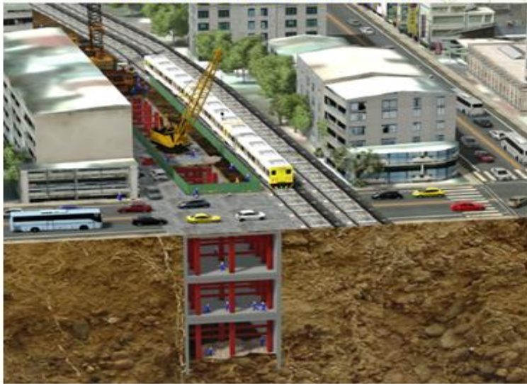
核定版明挖覆蓋施工模擬圖
